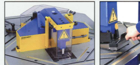
LB 13 / Quick Schnellwechsel-System der Messersätze
